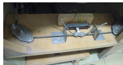
Aansluiting kabels richtingsroer en potentiometer
